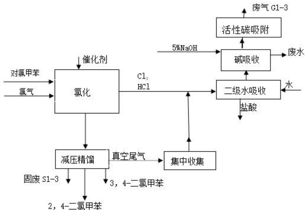
图 4.1-2 2, 4-二氯甲苯项目的工艺流程图
