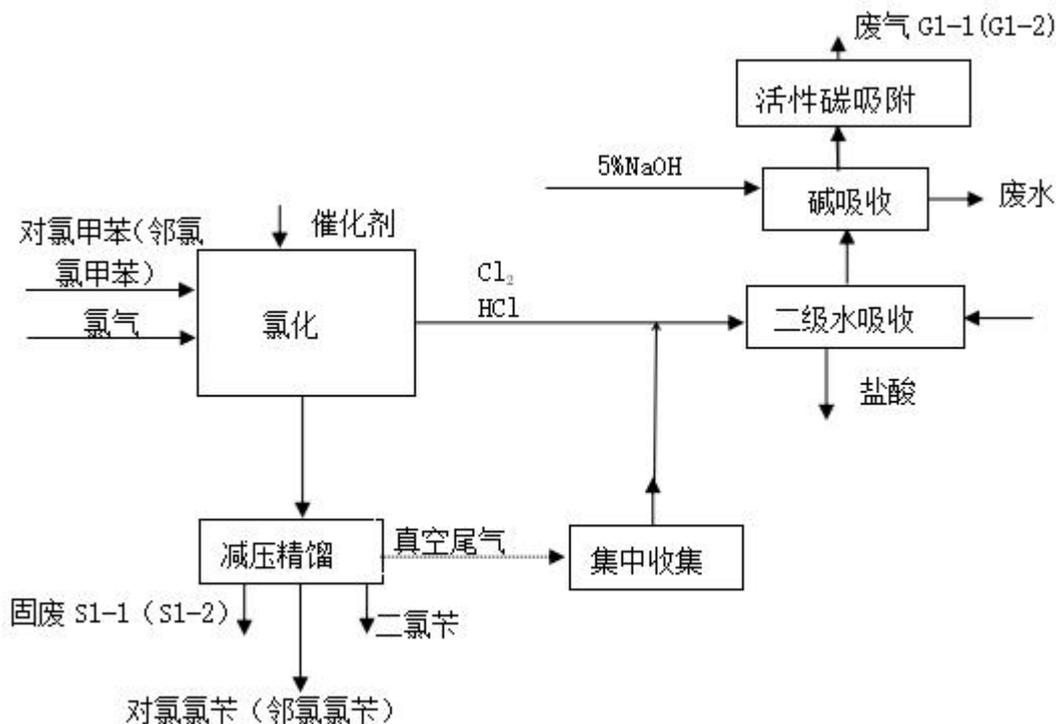
图 4.1-1 对氯氯苳（邻氯氯苳）项目工艺流程图
